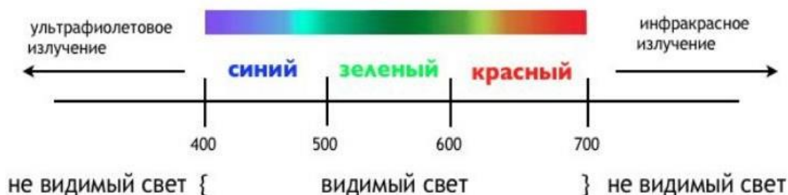
Рис. 23. Види оптичних спектрів [6]
