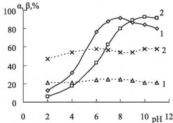
Рис. 1. Влияние pH растворов на: степень (α) флотационного извлечения соединений урана (VI) (1) и тория (IV) (2); степень (β) перехода раствора в пену (пунктирные кривые).
