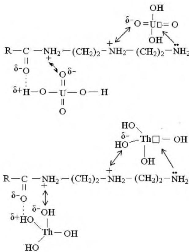
**Рис. 2.** Механизм взаимодействия соединений урана (VI) и тория (IV) с коллектором.
