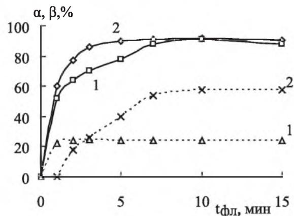
**Рис. 4.** Влияние времени флотации ( $t_{\text{фл.}}$ ) на: степень ( $\alpha$ ) флотационного извлечения соединений урана (VI) (1) и тория (IV) (2); степень ( $\beta$ ) перехода раствора в пену (пунктирные кривые).
