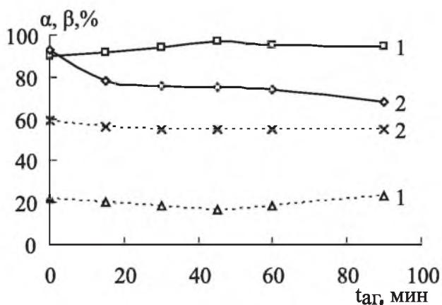
**Рис. 5.** Влияние времени агитации ( $t_{\text{аг}}$ ) на: степень ( $\alpha$ ) флотационного извлечения соединений урана (VI) (1) и тория (IV) (2); степень ( $\beta$ ) перехода раствора в пену (пунктирные кривые).
