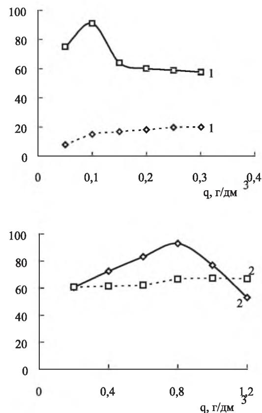
**Рис. 3.** Влияние расхода коллектора ( $q$ ) на: степень ( $\alpha$ ) флотационного извлечения соединений урана (VI) (1) и тория (IV) (2); степень ( $\beta$ ) перехода раствора в пену (пунктирные кривые).
