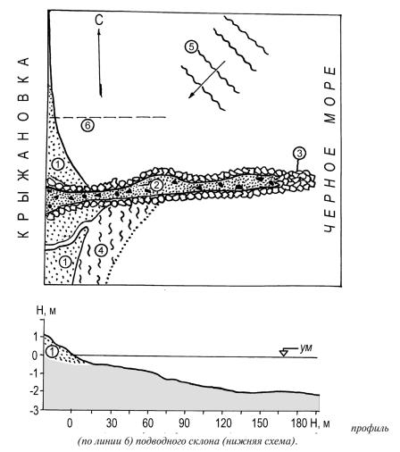
Условные обозначения: 1 — прислоненный песчаный пляж во «входящих углах» буны; 2 — песчано-щебневая поверхность буны; 3 — оголовок буны, состоящий из россыпи каменной наброски; 4 — накопления водорослей после штормов; 5 — гребни приходящих к берегу волн (стрелка — луч волны).
