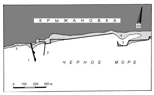
Рис. 2. Схема измененного берега Одесского залива во фронтальной части пос. Крыжановка в восточных предместьях Одессы. Цифровые обозначения: 1— «длинная» буна;
