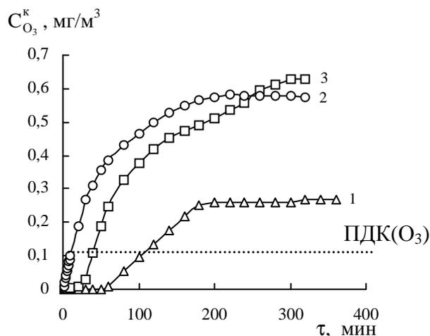
Рис. 4. Изменение конечной концентрации озона  $C_{O_3}^k$  во времени при разложении озона природными сорбентами: 1 – П-БТ(1)\*; 2 – П-Тр(К); 3 – П-Кл ( $C_{O_3}^H = 1 \text{ мг/м}^3$ ;  $m_k=10 \text{ г}$ ).
