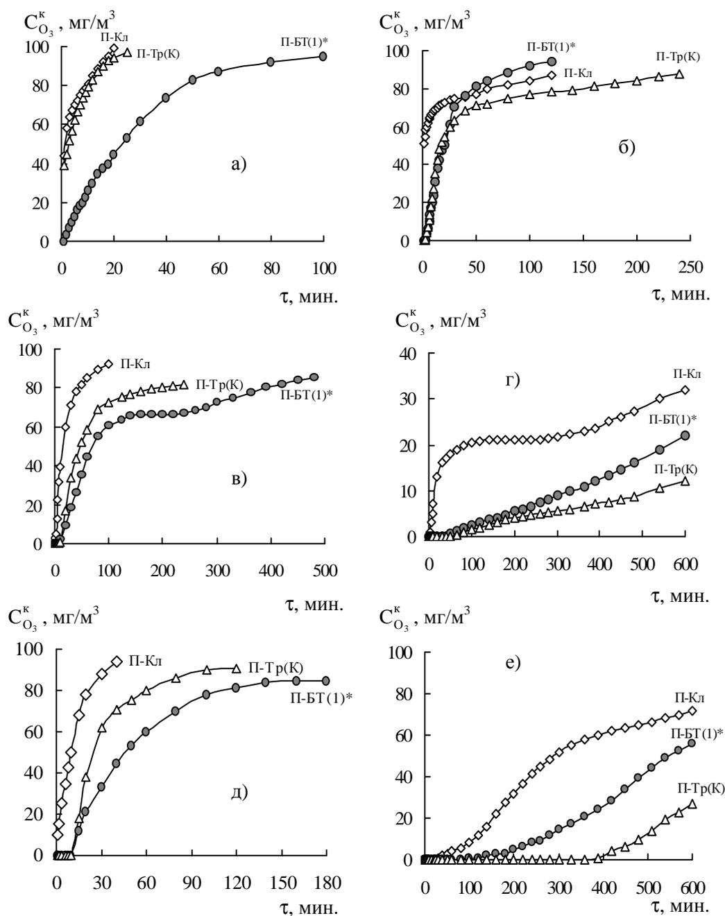
Рис. 3. Изменение конечной концентрации озона во времени при разложении его катализаторами  $CuCl_2/\bar{S}$  (а, б);  $CoCl_2/\bar{S}$  (в, г);  $MnCl_2/\bar{S}$  (д, е) при  $C_{MCl_2} = 1,2 \cdot 10^{-6}$  моль/г (а, в, д) и  $C_{MCl_2} = 1,2 \cdot 10^{-4}$  моль/г (б, г, е) ( $C_{O_3}^H = 100$  мг/м<sup>3</sup>).
