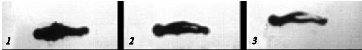
Рис. 4. (фото 1, 2, 3). Возмущение поверхности ядра под действием собственных колебаний вихревого кольца при движении в области переходного гидродинамического режима [10] в разные моменты времени: 1 – 0.85 с; 2 – 1.35 с; 3 – 3.05 с
