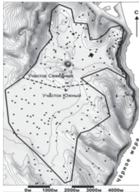
Рис. 1. Контуры участка на территории Одессы, для которого межгодовая динамика УГВ изучена методом интегральной оценки [13, 15] с шагом 1 месяц по 88 наблюдательным скважинам за период с 1972 по 2000 гг. Черные точки — наблюдательные гидрогеологические скважины
