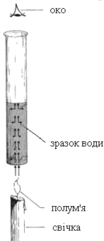
Рис. 1. Свічковий мутномір Джексона
